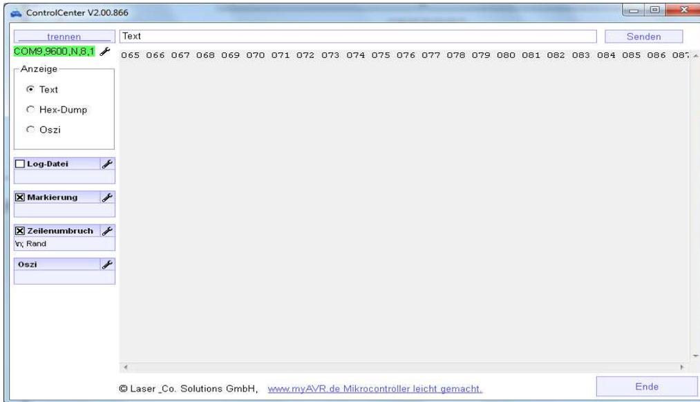
Die Anzeige kann über die Schaltflächen auf der linken Seite weiter konfiguriert werden. Dabei werden die Zeilengröße oder das Zeilenumbbruchzeichen sowie das Format der Zahlendarstellung (Hexadezimal/Dezimal) ausgewählt.
