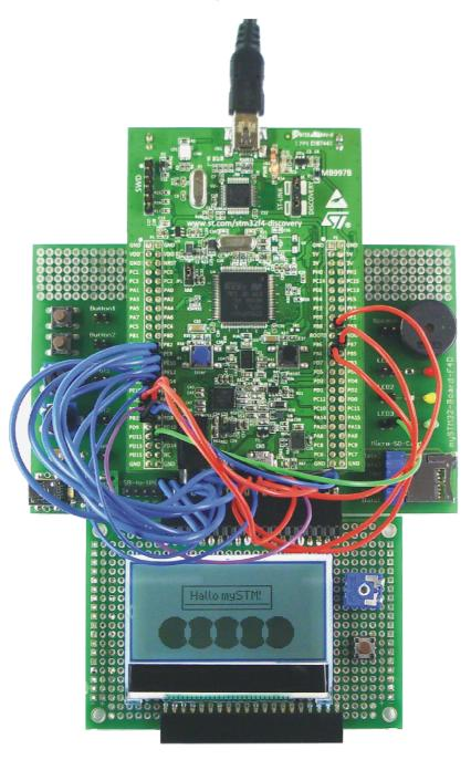
Verbindung mit dem GraficLCD Add-On.
